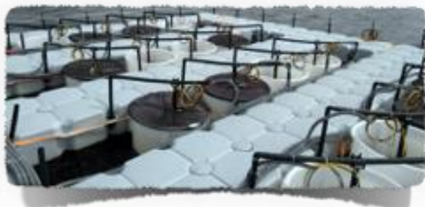
Mesoskosmer, med sensorer som bevakar temperatur, pH, syre, ljus etcetera.
